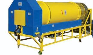
این دستگاه با ظرفیت اسمی حداقل ۱۰۰۰ کیلو در ساعت در مدل مخزن جدا نواری و دهن بست ریز نواری و توری قابل تعویض و حفاظ جلوی دستگاه تولید می شود که مشخصات دستگاه عبارت است از
