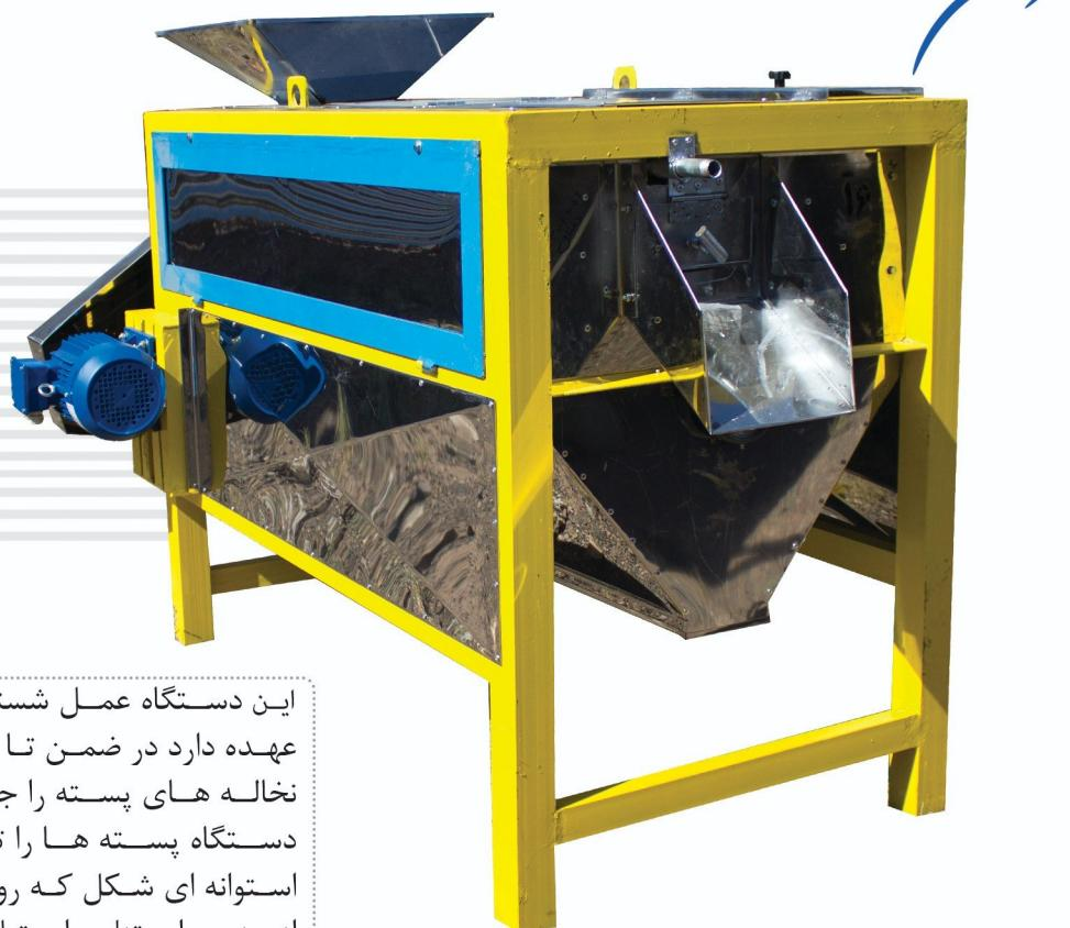
این دستگاه عمل شستشوی پسته را بر عهده دارد در ضمن تا حد قابل توجه ای نخاله های پسته را جدا می کند این دستگاه پسته ها را توسط یک توپی استوانه ای شکل که روی آن مارپیچ هایی از جنس استیل میگذرد متصل شده است بطرف جلو هدایت می کند و در طول مسیر توسط نازل هایی آب با فشار روی پسته ها می پاشد
