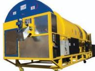
دستگاه با ظرفیت اسمی حداقل ۱۴۰۰ کیلو در ساعت همراه قطع کن نوار و مخزن جدا نواری و دهن بست ریز نواری و توری قابل تعویض و حفاظ جلوی دستگاه تولید می شود که مشخصات دستگاه عبارت است از
